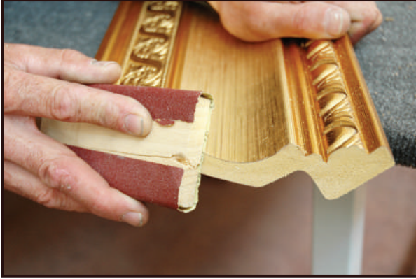
Decolux kesim yerlerinden zımpalanır
